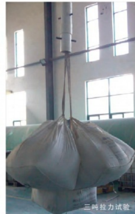
三吨拉力试验
